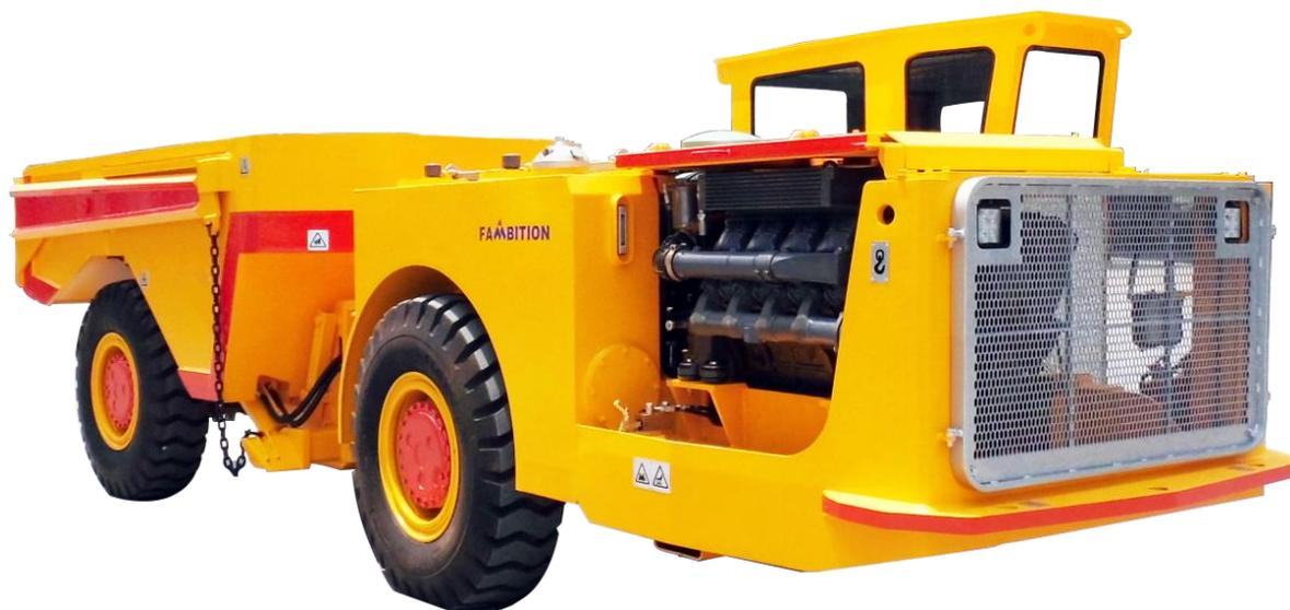
FT15A грузоподъемностью 15 тонн предназначен для сечения выработки 3\*3 метров, сочетает работать вместе с расширенными стрелами FL06A погрузо-доставки. FT15A оснащен боковое сиденье открытой кабиной, и тоже можно выбирать сиденье направления вперед закрытой кабиной.
